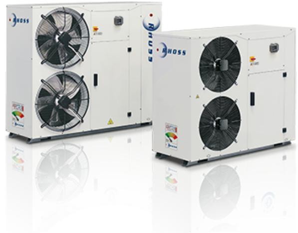
**Bombas de calor reversibles monobloque con condensación por aire y ventiladores helicoidales. Serie de compresores herméticos tipo scroll y gas refrigerante R410A.**
